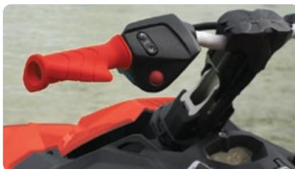
Система регулировки дифференциала VTS™ с расширенным диапазоном
